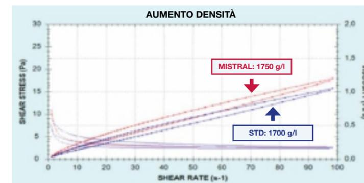
**L'aumento della densità di una barbotina è possibile solo se si mantengono buone condizioni reologiche.**
